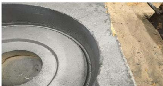
ภาพแสดงขอบของแม่พิมพ์ที่ไม่เรียบทำให้มีช่องว่างตะเข็บตอนประกบพิมพ์
