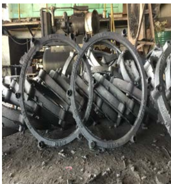
ภาพแสดง ชิ้นงานที่ได้ถอดแบบจากแบบไม่เรียบ (วงในและวงนอก) ทำให้ต้องเสียเวลาในตัดแต่งมาก
